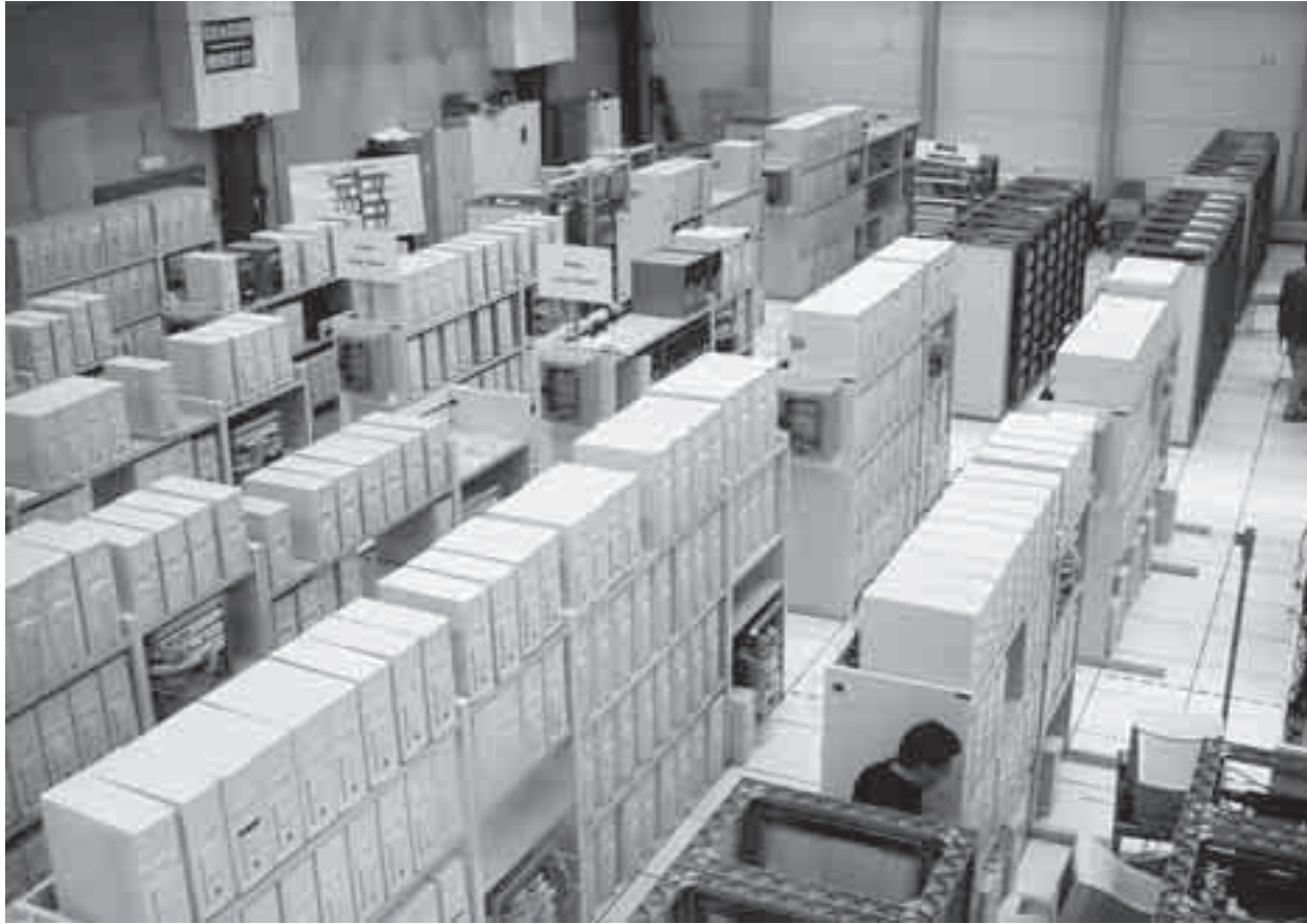
Palvelinfarmi. Hiukkaskiihdyttimien suoltaman massiivisen tietomäärän analysointiin tarvitaan paljon laskentatehoa; kuvassa on vain pieni osa CERNin omasta tietokonekeskuksesta.
