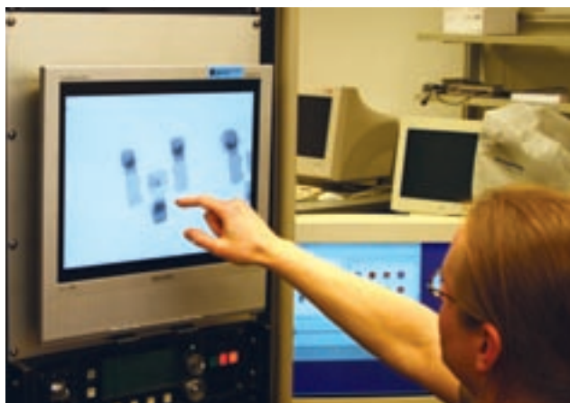
Röntgenkuva osoittaa piirilevyn virhejuotot.
