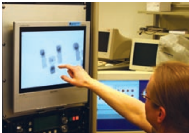
Röntgenkuva osoittaa piirilevyn virhejuotot.
