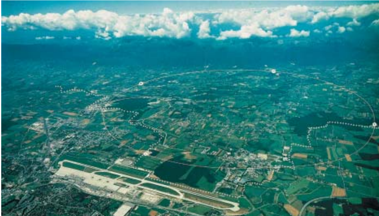
Ilmakuva Cernistä. Suuri ympyrä näyttää rakenteilla olevan LHC-kiihdytintunnelin radan; ympärysmitaltaan se on 27 km. Radalle on merkitty ympyröillä kiihdyttimen koeasemat, joilla varsinaiset mittaukset tehdään. Tähdillä on merkitty Sveitsin ja Ranskan rajaa, ja taustalla näkyvät myös Jura-vuoret.
